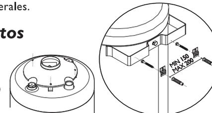
d) Estos modelos presentan como ventaja un sistema de colgar por medio de un soporte superior trasero soldado al gabinete, apoyado sobre dos soportes metálicos de pared (C) provistos en la bolsa de accesorios con sus correspondientes tarugos plásticos (E) y tornillos (D), a la altura más conveniente para su anclaje sin necesidad de usar enganches o ménsulas especiales. Facilitando totalmente la limpieza debajo del mismo.
