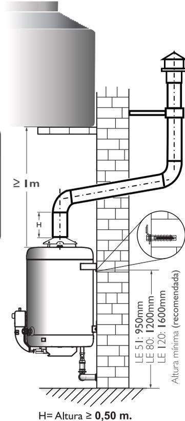
\* El termotanque puede ser instalado debajo del tanque de agua. Deberá mantenerse un desnivel mínimo de 1m. entre la base del tanque de agua, y la tapa superior del termotanque. Se puede necesitar mayor diferencia, si la característica de la instalación lo requiere.
