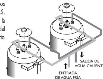
\* Si la instalación requiere de un gran consumo y demanda de agua caliente, superior a la prestación de un único artefacto, le sugerimos una instalación de termotanques en paralelo (Ver croquis) ó consulte llamando a nuestro departamento técnico. Dos o más unidades pueden abastecer en simultáneo a toda la red de agua caliente.
